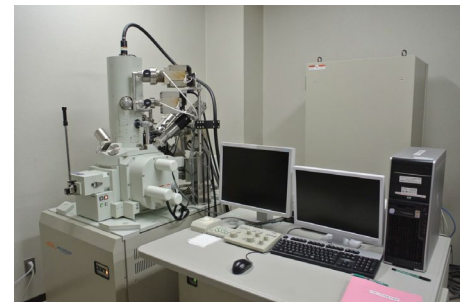
FIB/SEM複合装置 JEOL JIB-4600F 加工、表面・断面観察
