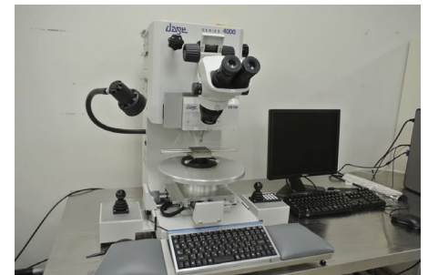
ダイシエータテスト装置 デイジ 4000P 接合強度の評価
