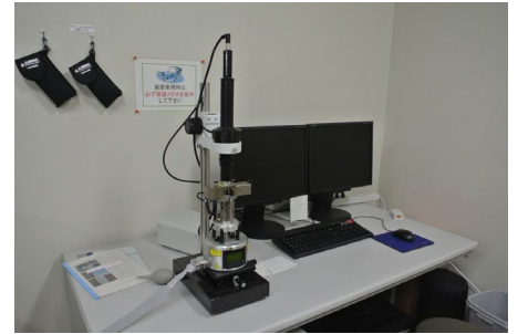
SCM/SPM装置 日本ビーコ MultiModeVS SPM 表面形状観察
