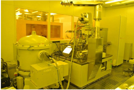
電子線描画装置 JEOL JBX-6300 4.5inch角フォトマスク、φ4inch Siウエハ対応
